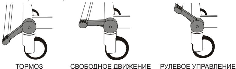
Рис. 17. Тормоза и рулевое управление
